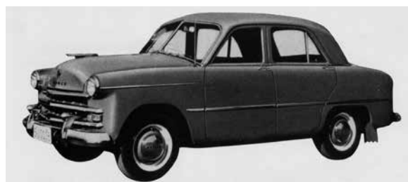
プリンスセダンAISH-I(1952) プリンス自動車工業 エンジンは富士精密工業製FG4A型1500cc-45hpエンジンを搭載。
