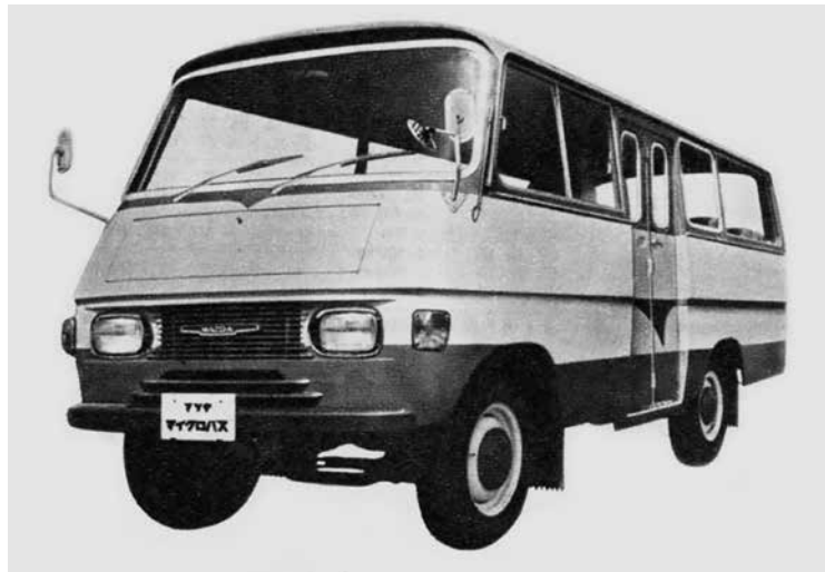
DUC9 (1971年) L4980 W1840 H2200 WB2600 95km/h (UA) G-L4-1484cc 60ps 定員18名 1971年のマイナーチェンジ車。プレートに「マ イクロバス」の表記があるが定員18名で、当時 の『自動車ガイドブック』には「マツダ ライト バス DUC9」と記載されている。
