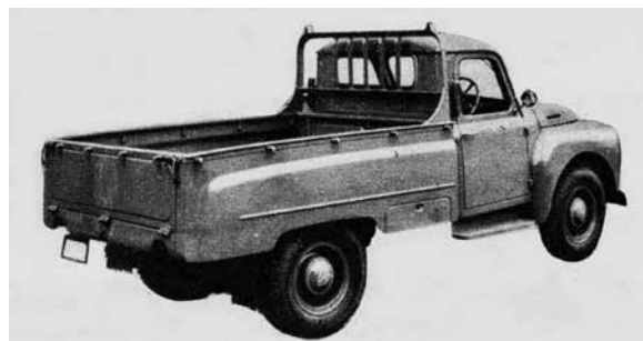
AFTF(1952年) プリンス自動車工業 富士精密工業製FG4A型1500cc-45hpエンジンを搭載。
