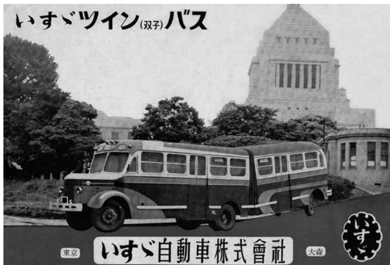
BX95 (改) ツインバス (1950年) L11100 W2400 H2750 WB4300+4300 60km/h 〈DA45〉D-L6-5103cc 90hp 定員75名 BX91にシャシを改造結合した双子バスで、 青森県の八戸市交通局に納入された。
