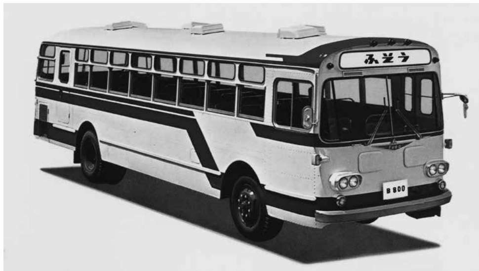
B800J/B805J (1967年8月発売) L10275 W2490 H3070 WB4900 110km/h (6DC2) D-V6-9955cc 200ps 定員79名 DC系V型エンジン開発に伴いモデルチェンジ。800系(写真)がリーフサス、805系がエアサス。末尾の記号はWBを示す。J:4900mm、K:5200mm、L:5400mm、M:5650mm。
