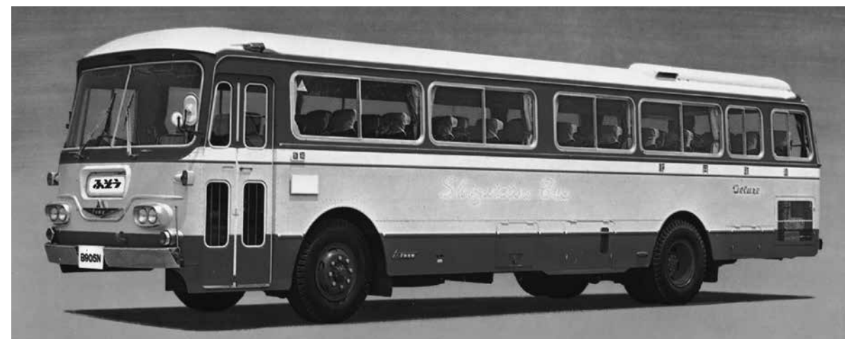
B905N 高速バス (1967年8月発売) L11255 W2490 H3085 WB5700 130km/h (8DC2) D-V8-13273cc 265ps 時速100kmの連続走行に十分耐えるよう設計された高速バスで、ターボ付320psの8DC2型エンジンを搭載したB905NSもある。
