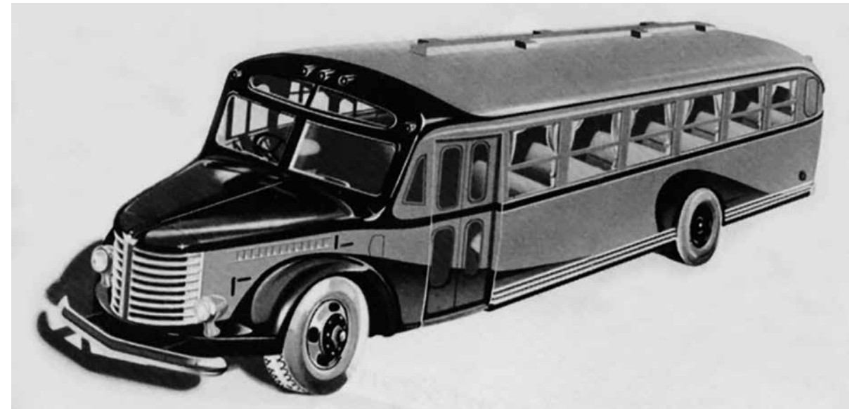
BH10 初期型 (1950年3月発売) L9400 W2400 H2760 WB5000 70km/h <DS10> D-L6-7014cc 105hp 初期型はボンネットフードのモールがない。低床式フレーム、エアブレーキ採用。
