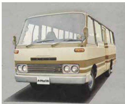
パークウェイ126 AEXC (1972年) L6195 W1980 H2325 WB3285 95km/h <XA> D-L4-2701cc 81ps
