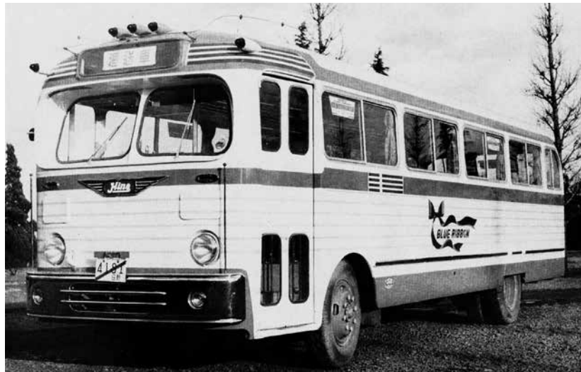
BD10 初期型 (1952年10月発売) L10000 W2450 H2950 WB4800 70km/h 〈DS20〉 D-H6-7014cc 110hp 床下エンジンは重心が低く、床面積も広く使えるのが特徴。BD10は前扉、BD30は中扉。 初期型は、バンパー形状などが異なる。
