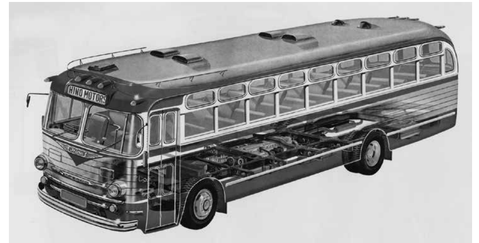
BD系の透視図。BD系センターアンダーフロアエンジンバスはエンジンが車体の中心にあり、車両に安定性がある。エアブレーキ採用。
