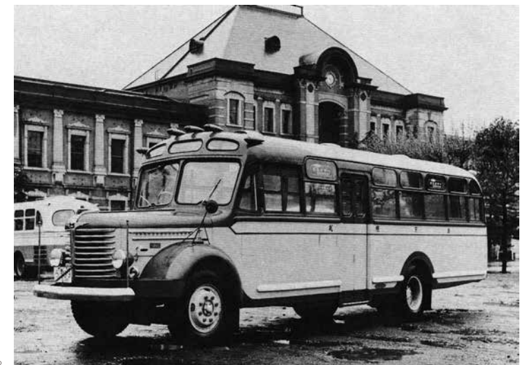
BH10 (1950年) L9400 W2440 H2760 WB5000 <DS10> D-L6-7014cc 110hp 定員63名 WB5500mmのBF10、4500mmのBA10もある。
