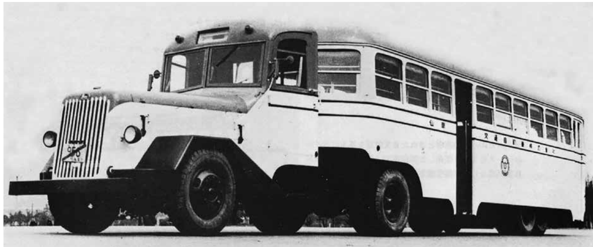
T11B+T25 トレーラバス (1947年7月完成) L5500(トラクタ)+7050(トレーラ) W2350 H2400 <DA54> D-L6-10850cc 110hp 定員96名 終戦時、工場内に残されていた6トン牽引車のDA54型水冷ディーゼルエンジンを搭載。
