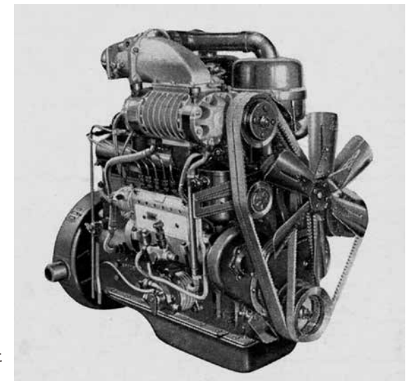
DA48S型 ディーゼルエンジン (1955年) 予燃-L6-5654cc スーパーチャージャー付 最高出力115hp/2600rpm 最大トルク36.0kgm/1500rpm BX系ボンネットバスやBX-X系リアエンジンバスに 搭載された。
