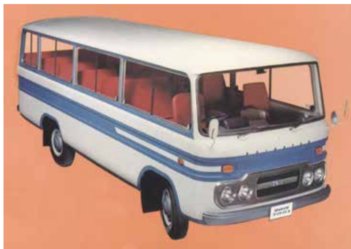
SV37N ライトバス (1969年) L6100 W1920 H2260 WB3200 95km/h <DC> D-L4-2530cc 75ps 定員25名
