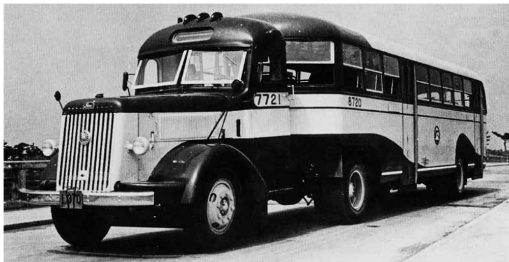
T13B+T26 トレーラバス (1954年) L13850(連結時) W2400 H3050 52km/h <DA55> D-L6-10850cc 115hp 定員96名 1954年7月発売。フェンダーが丸くなり、搭載エンジンはDA55型になった。最大乗車人数150名。
