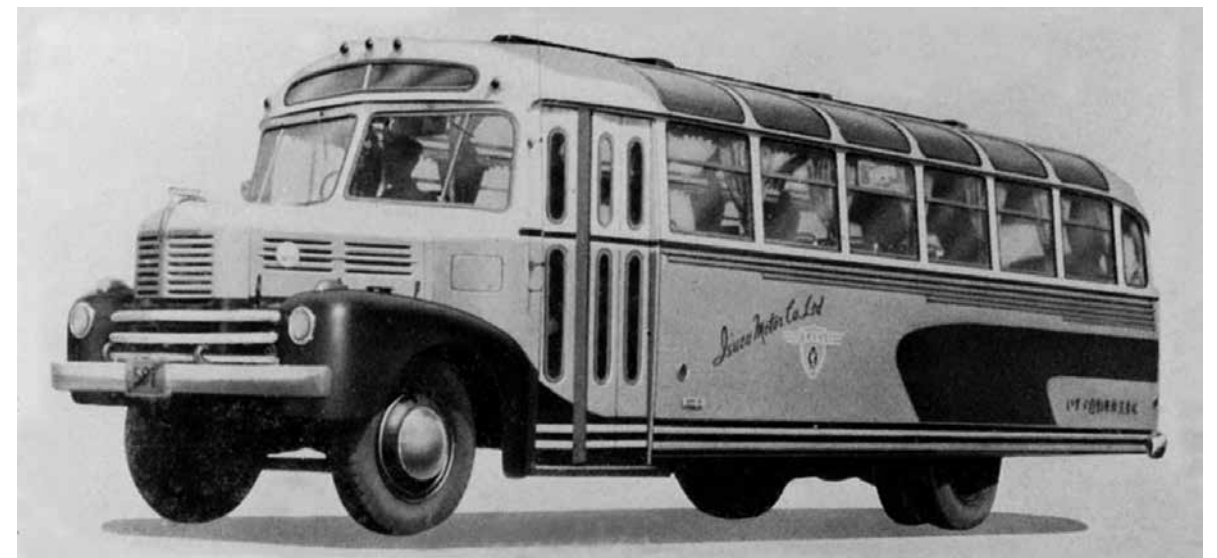
BX95 デラックスバス (1951年) L8790 W2450 H2840 WB5000 〈DA45〉D-L6-5103cc 90hp 定員42名 天井窓による採光、前後5段可動装置付シート、自動開閉式の出入口扉、ゴムマット採用等の斬新な設計。
