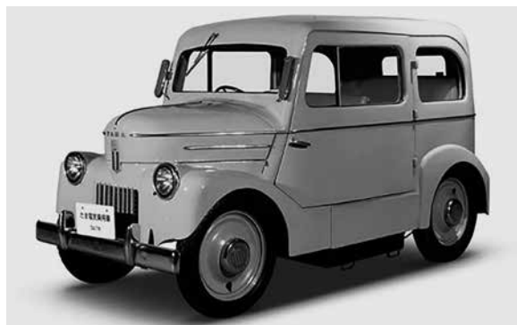
たま電気自動車(1947年6月発売) 東京電気自動車 オオタHA乗用車ベース。一充電で65km、45km/hで走行した。
