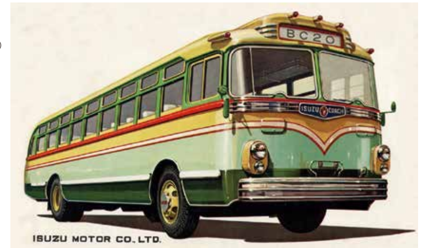
BC20 (1957年) L10300 W2480 H3000 WB5350 73km/h <DH10> D-L6-9348cc 150hp/180hp (スーパーチャージャー) 定員74名
